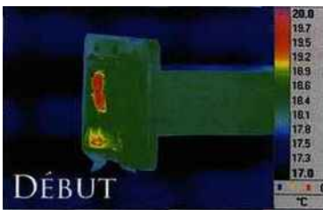
▲ Dispositif de test du niveau de puissance létal : un frelon est placé dans un tube devant l'ouverture d'un guide d'onde servant de source de micro-ondes de puissance ajustable
