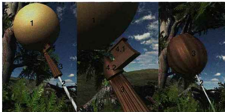
▲ Illustration du principe du four aux micro ondes déployable. Le nid (1) est atteint à l'aide d'une perche télescopique (2) dotée d'une chambre réverbérante déployable (3) et d'une source de micro ondes (4). Les micro ondes sont alors complètement confinées ce qui augmente le rendement et protège l'environnement et les utilisateurs.
