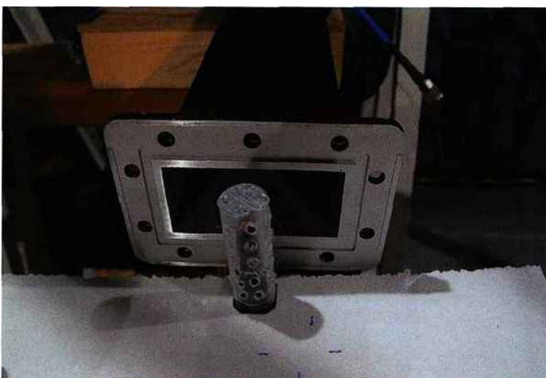
▲ Dispositif de test du niveau de puissance létal : un frelon est placé dans un tube devant l'ouverture d'un guide d'onde servant de source de micro-ondes de puissance ajustable)
